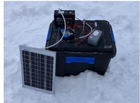
Foto 5. Päikeseenergia õppeskeem päikesepaneeli, aku, kontrolleri ja tarbijaga
