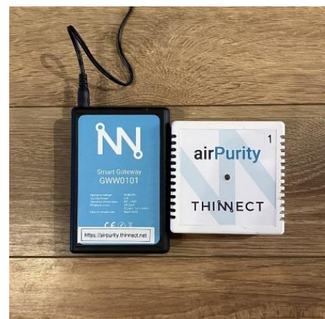
Foto 4. Hoone sisekliima mõõtmise andur (paremal) ja võrguseade andmete edastamiseks serverisse
